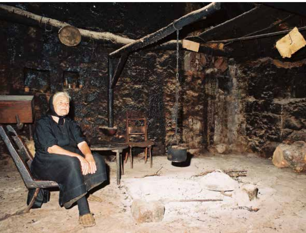
Mehanička naprava „vitlo“ iznad komina na kojoj domaćica lako smiče lonce i kotluše s vatre za domaćicu je „civilizacijska“ stečevina. Nisko ognjište za domaćicu je nezahvalno (zbog saginjanja), ali je povoljno za one koji se uz vatru griju.
