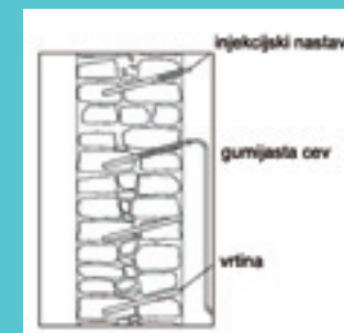
Sistematično injektiranje zidov • Vir: Arhiv Mojca Jarc Simonič
