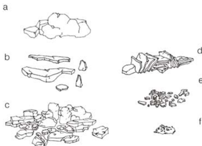
Slika 6: Priprava gradiva za gradnjo na suho.
