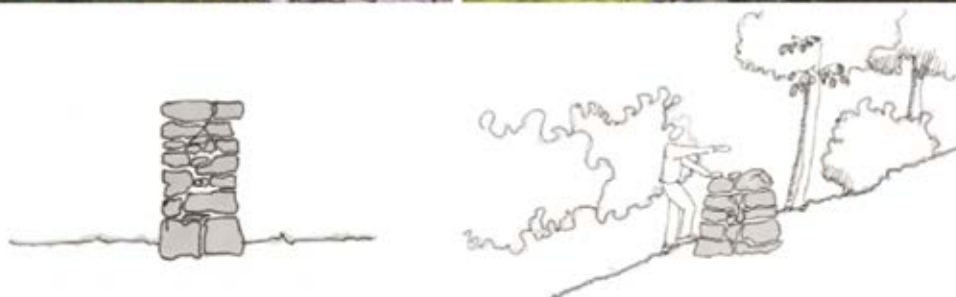
Slika 23: Variacija dvojnega zidu. Zid v gozdu (leva fotografija) ima obrnjeno tektoniko zidanja. Namesto spodaj so večji kamni zgoraj. Zidan je z majhnimi kamni, večji kamniti bloki na vrhu imajo funkcijo utrjevanja zidu. Zid ima funkcijo mejnega zidu in je hkrati z velikimi kamni zaščiten pred rušenjem. Divjad skače čezenj in z nogami občasno udari v venec - če bi bili kamni drobni, bi jih divjad s preskoki zbijala na tla. Drug primer dvojnega zidu, ki smiselno sledi konfiguraciji terena. Tlorisna ločna oblika zidu je stabilnejša od ravne linije. Zid je grajen na tradicionalen način, stranice zidu ima v naklonu. Fotografiji: Borut Juvanec.
